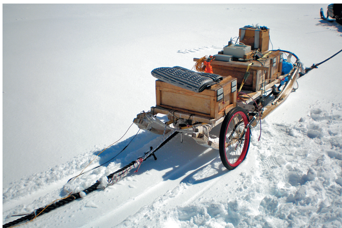
Рис. 4. Моноимпульсные локаторы ВИРЛ-6 (а) и ВИРЛ-2 (б) с центральной частотой 20 МГц
