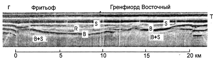
Рис. 2. Отражения от границы раздела сухого холодного и теплого водосодержащего льда (R) на леднике Фритьоф по данным аэроадиозондирования 1979 г. на частоте 620 МГц.
