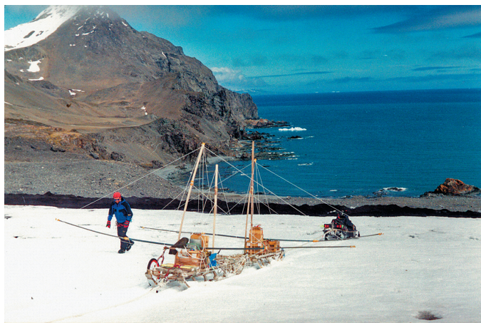
Рис. 4. Моноимпульсные локаторы ВИРЛ-6 (а) и ВИРЛ-2 (б) с центральной частотой 20 МГц
